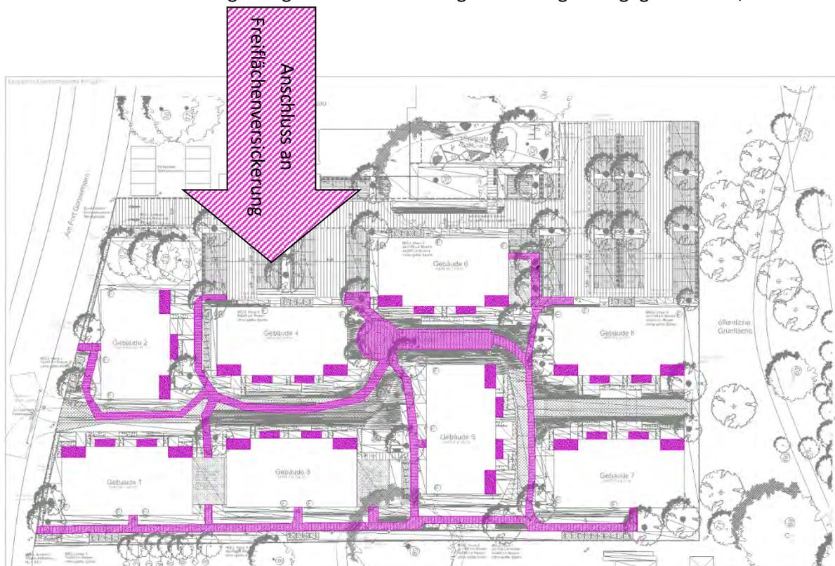
Abbildung 2: Übersicht der über die Flächenversickerung entwässerten Bereiche
