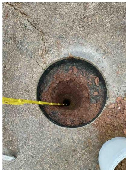
Abbildung 14: Bohrkern- und Bodenmaterialent-nahme für Untersuchung zur Schadensfeststellung
