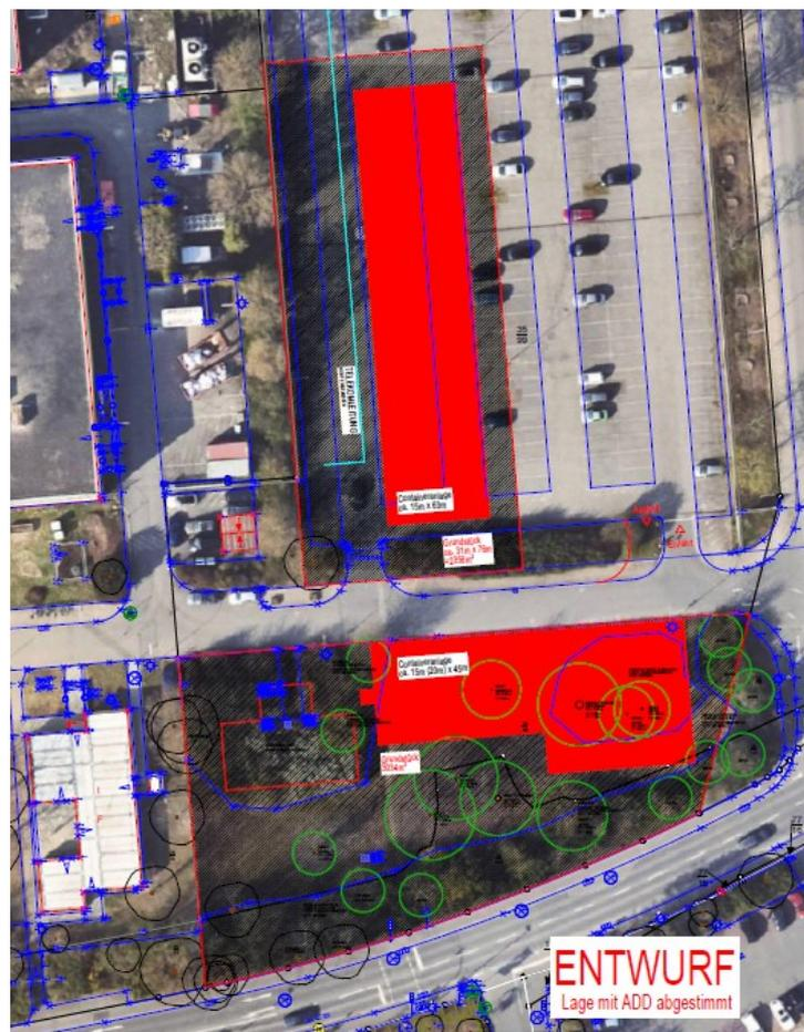
Durch die Notwendigkeit einer zweiten Containeranlage kann mit dem Bau der Tiefgarage/Sporthalle erst nach der Niederlegung und dem Neubau von Gebäude B und dem Rückbau der Container gestartet werden.
