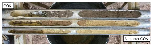
Foto 1: Bohrgut der Bohrung RKS 1 ab 0,0 m bis 3,0 m unter GOK
