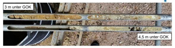
Foto 2: Bohrgut der Bohrung RKS 1 ab 3,0 m bis 4,5 m unter GOK
