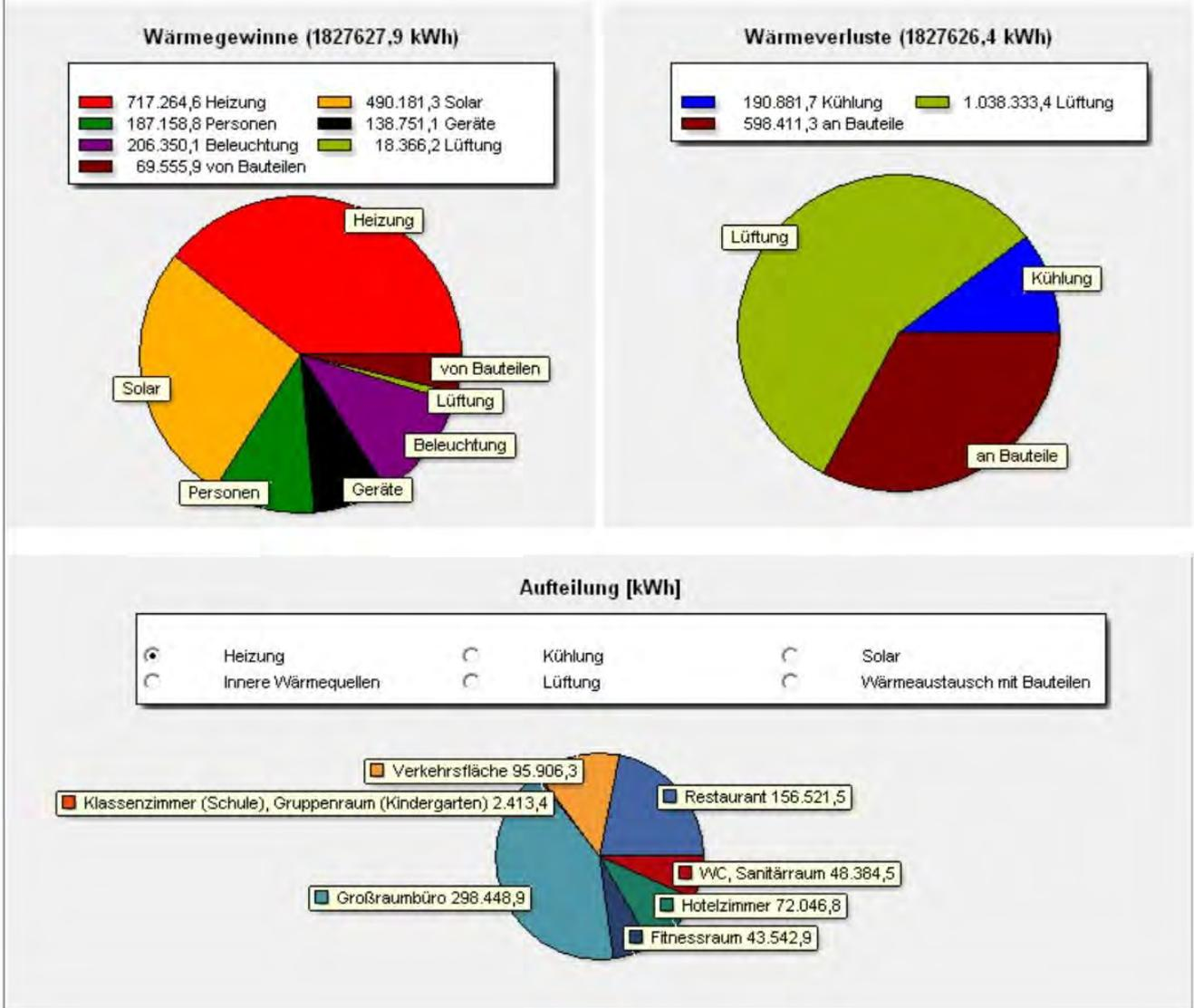
Abbildung 14 Simulierte Wärme- und Kältebedarfe für das gesamte Gebäude
