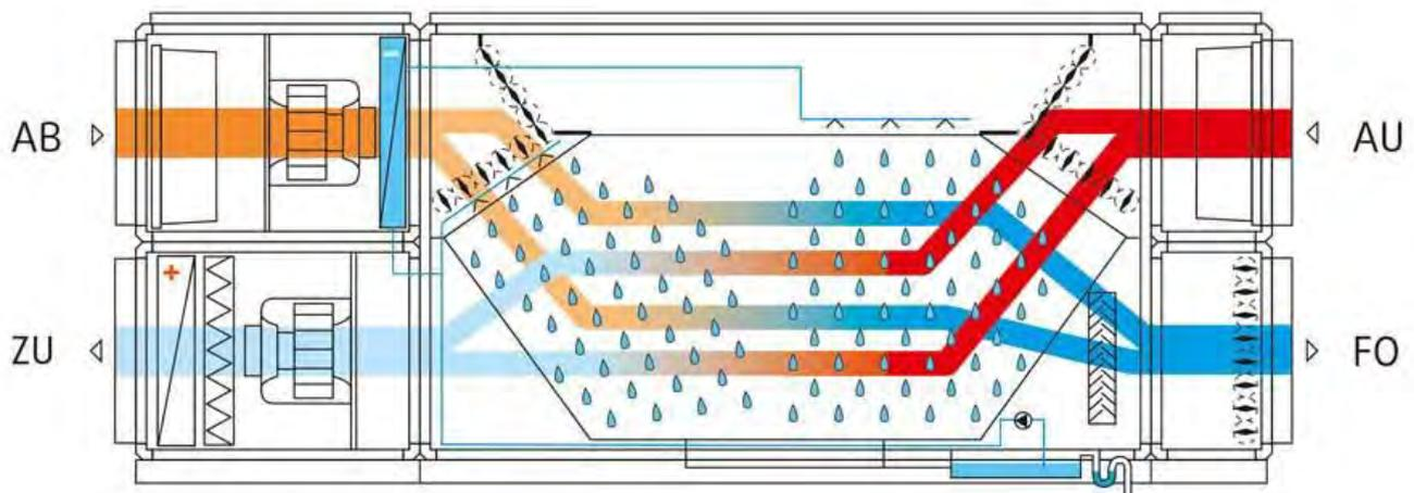
Abbildung 20 Adiabatischer Kühlprozess mit direkter Wassereinspritzung
