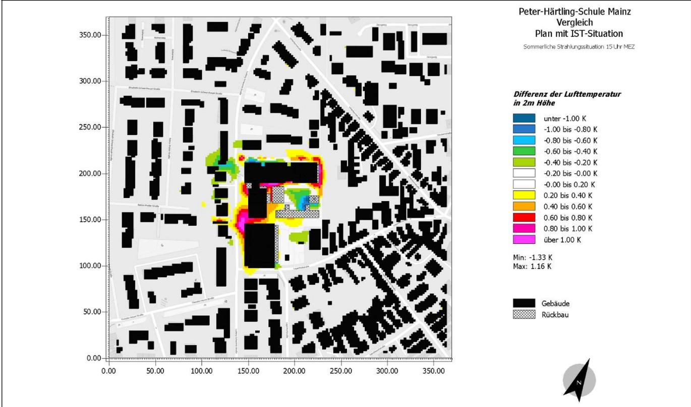
Abb. 17 Differenzen der Lufttemperaturen um 15 Uhr: Planszenario minus IST-Zustand
