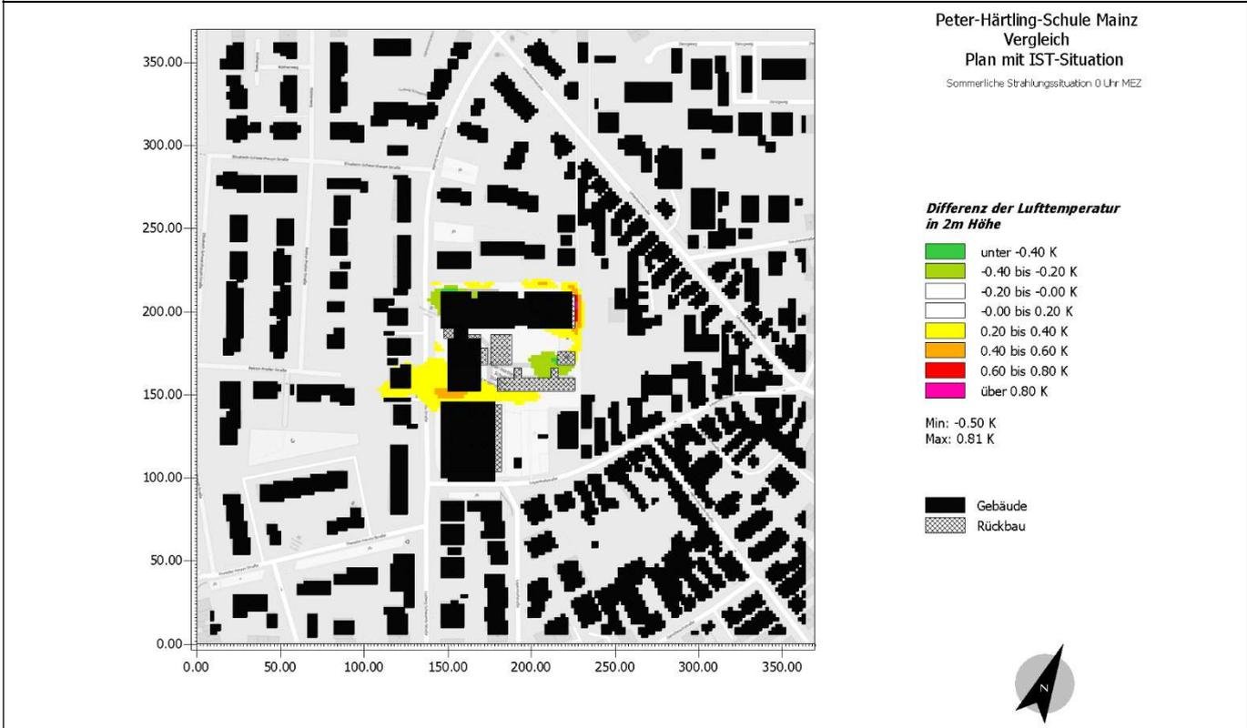
Abb. 18 Differenzen der Lufttemperaturen um 0 Uhr: Planszenario minus IST-Zustand
