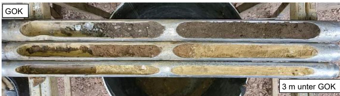
Foto 1: Bohrgut der Bohrung RKS 1 ab 0,0 m bis 3,0 m unter GOK
