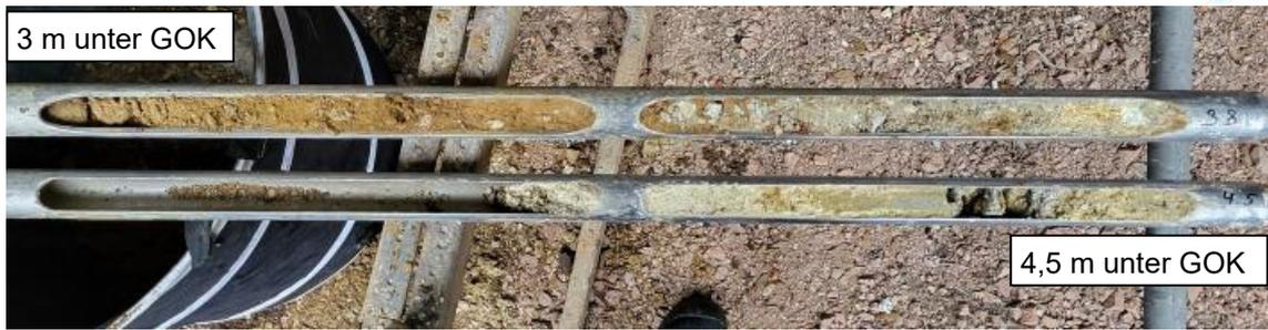
Foto 2: Bohrgut der Bohrung RKS 1 ab 3,0 m bis 4,5 m unter GOK
