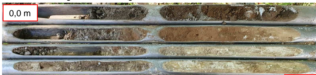
Foto 1: Bohrung RKS V1 von 0,0 m bis 4,0 m Tiefe
