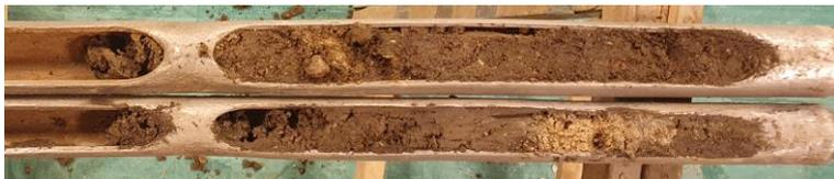
Bohrgut aus der Bohrung RKS-BL3
