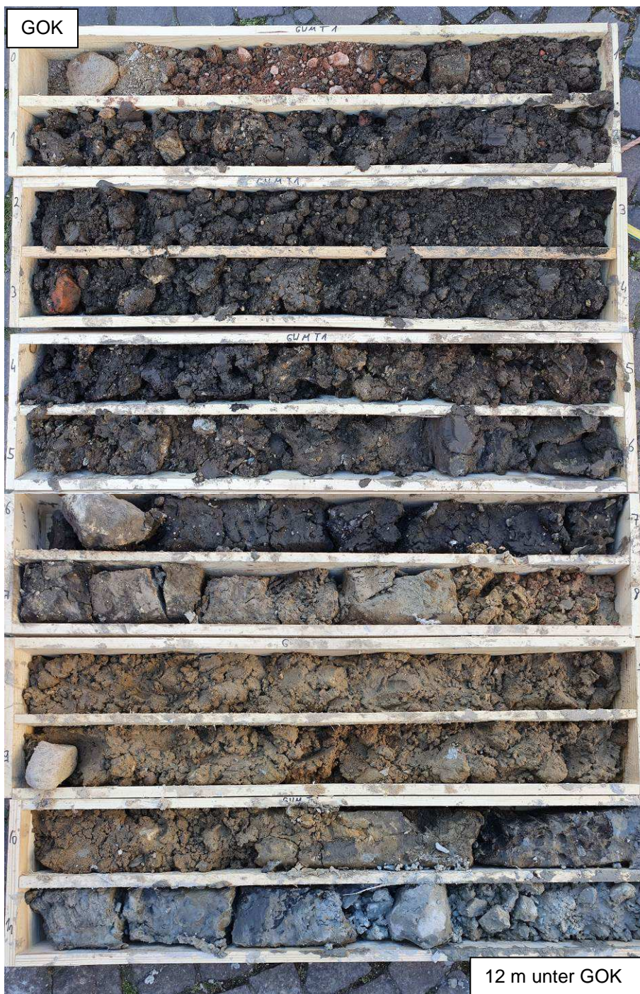
Foto 1: Bohrgut aus der Bohrung GWM-B1 bis 12,0 m unter GOK
