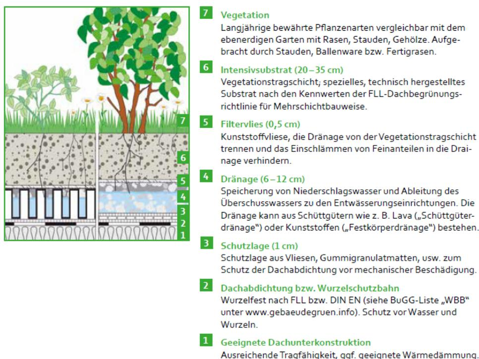
Abbildung 2: Schichtaufbau intensive Dachbegrünung<sup>18</sup>
