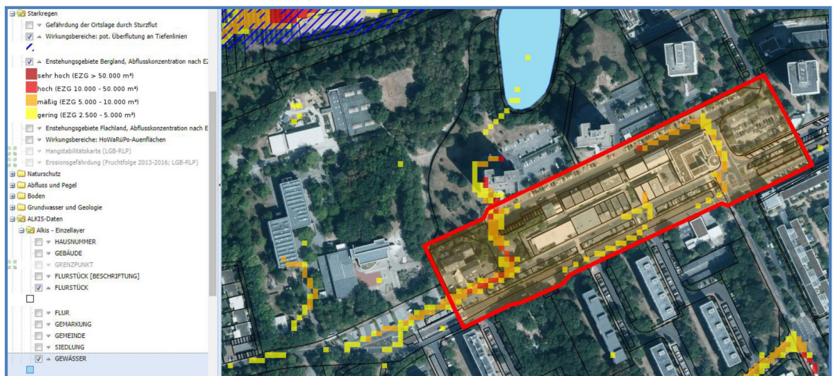
Abbildung 7: Starkregengefahrenkarte Ausschnitt im Bereich „Le 4“ (Abbildung unmaßstäblich, Quelle: SGD Süd 2022)
