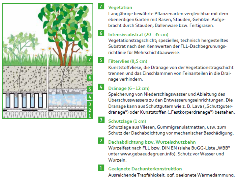
Abbildung 2: Schichtaufbau intensive Dachbegrünung 18
