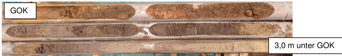
Foto 1: Bohrgut aus der Bohrung RKS 6 zwischen 0,0 m bis 3,0 m unter GOK
