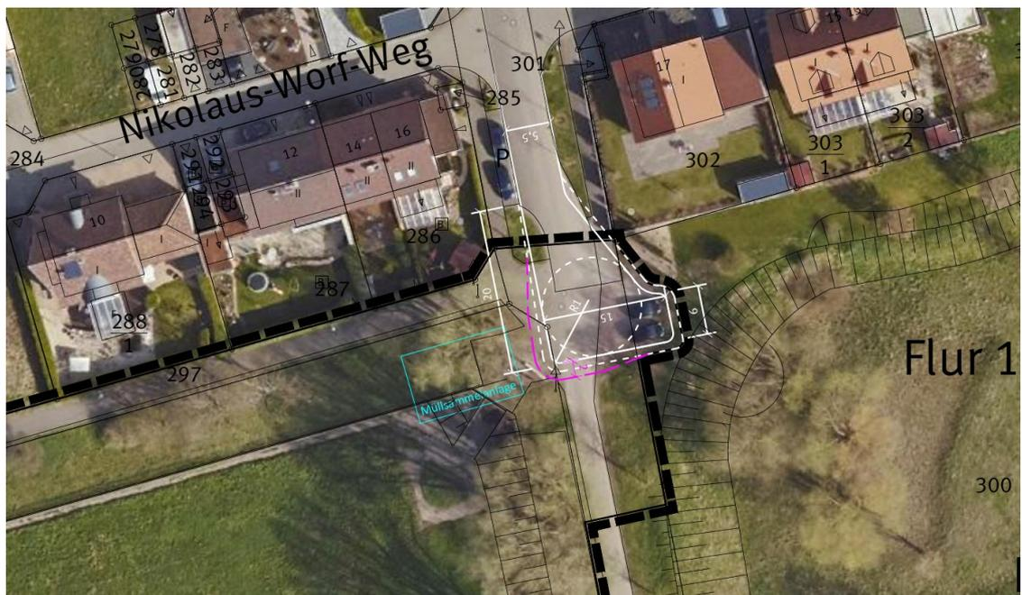
Abb. 7: Wendeanlage für ein 3-achsiges Müllfahrzeug (MFZ) gem. RAST 06 (weiße Linie) und fahrzeugtechnisch bedingte Erweiterung des Freihaltebereichs (pinke Linie)
