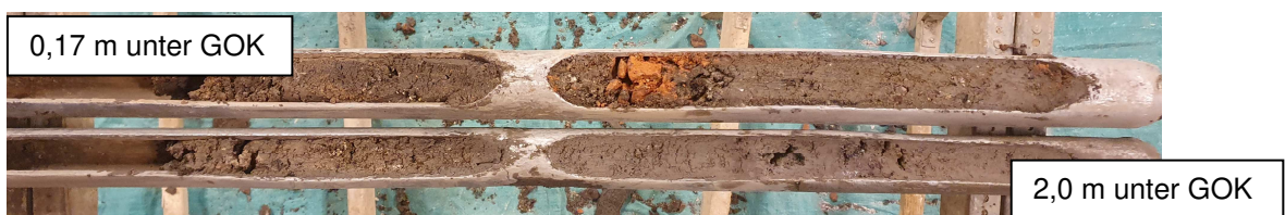
Foto 4: Bohrgut aus der Bohrung RKS BL 2 zwischen 0,17 m bis 2,0 m unter GOK
