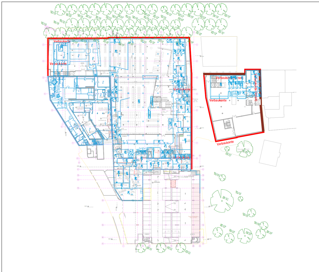
Abb. 4: Entwurfsplanung, LU UG - Bäume + Verbau (Stand: 02.02.2022). Quelle: Faerber Architekten, Mainz. Vom Auftraggeber zur Verfügung gestellt.
