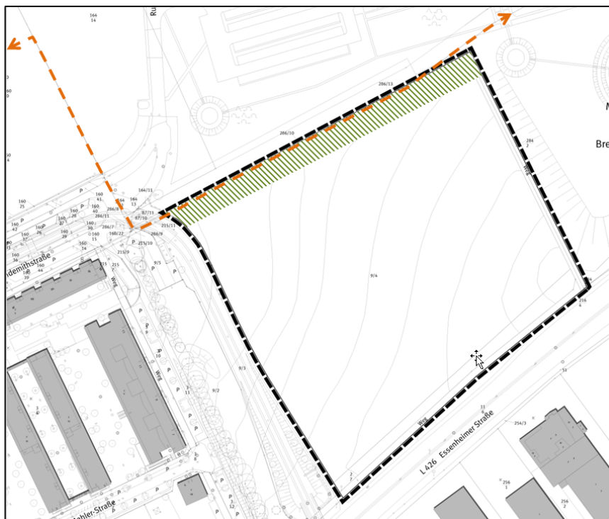
Abbildung 10: Verlauf der Fernwärmetransportleitung sowie des Schutzstreifens (5 m).
