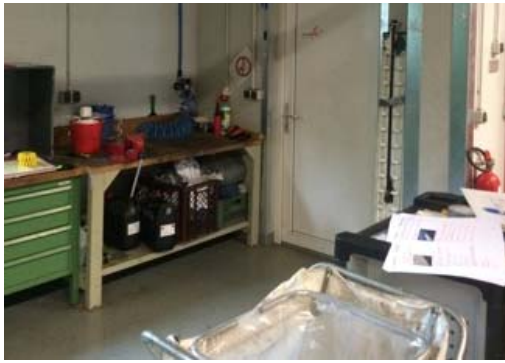
Abb. 37_Offene Lagerung von brennbaren Flüssigkeiten in Fahrzeughalle
