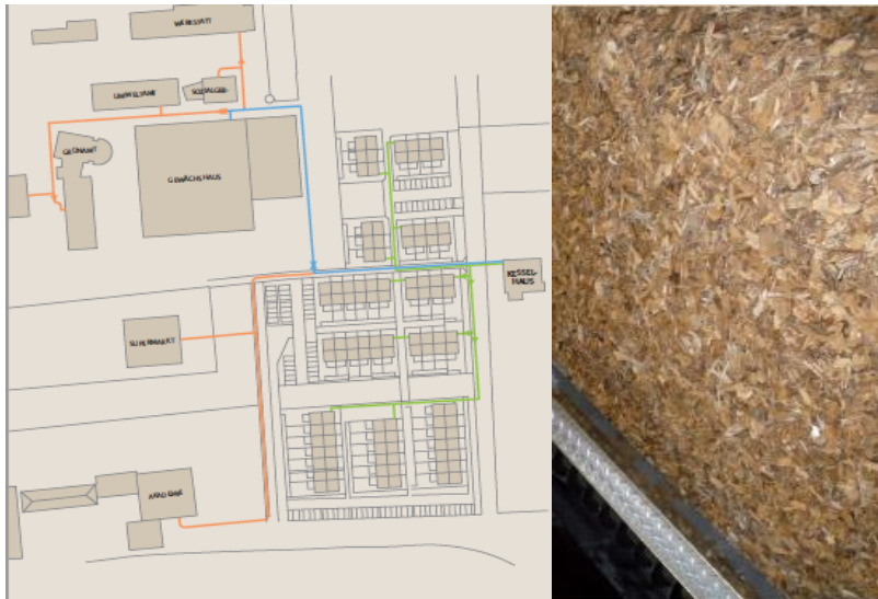
Abb.: Holzhackschnittel-Heizanlage mit Nahwärmenetz (Betriebshof Amt 67)
