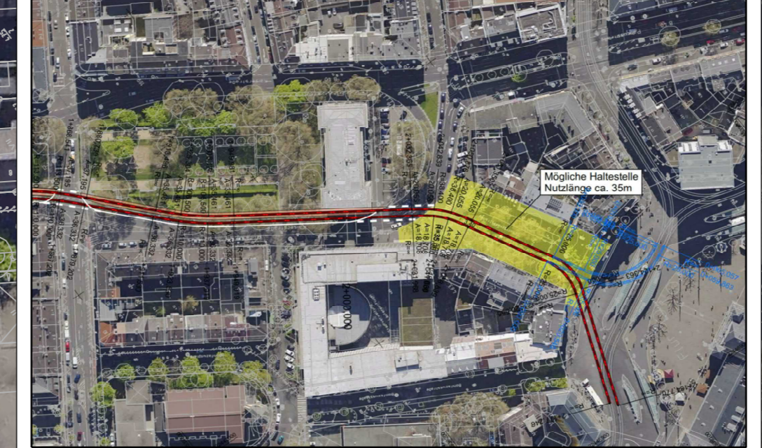
Alternative: 2-gleisige Strecke mit Anschluß Schottstraße
