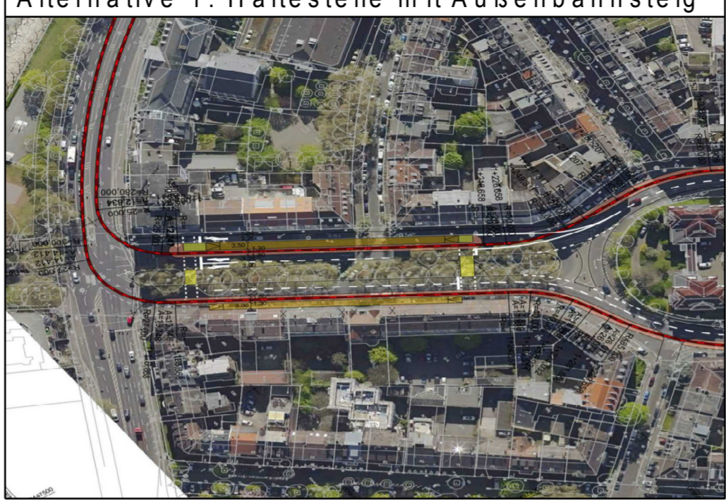
Alternative 1: Haltestelle mit Außenbahnsteig
