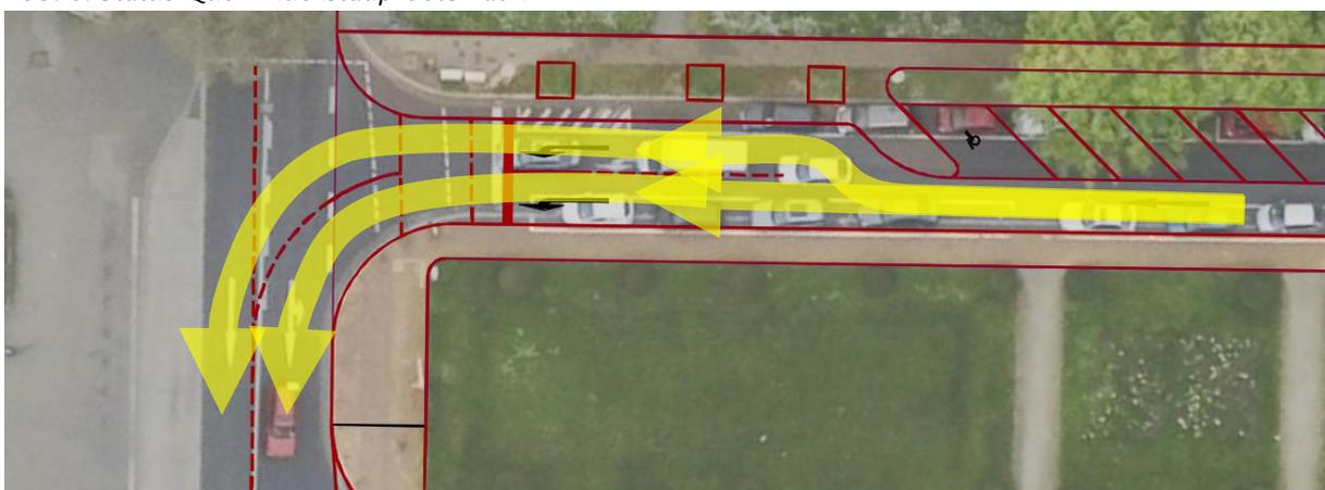
Abb. 9: zwei Abbiegespuren sorgen für einen besseren Verkehrsfluss
