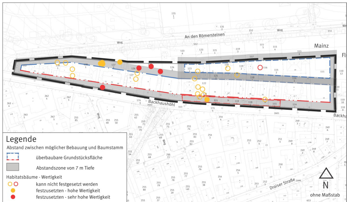
Abb. 7: Auswahl hochwertiger Bäume für zeichnerische Festsetzung durch Abstandsmessung zu überbaubaren Grundstücksflächen sowie durch Einzelfallprüfung
