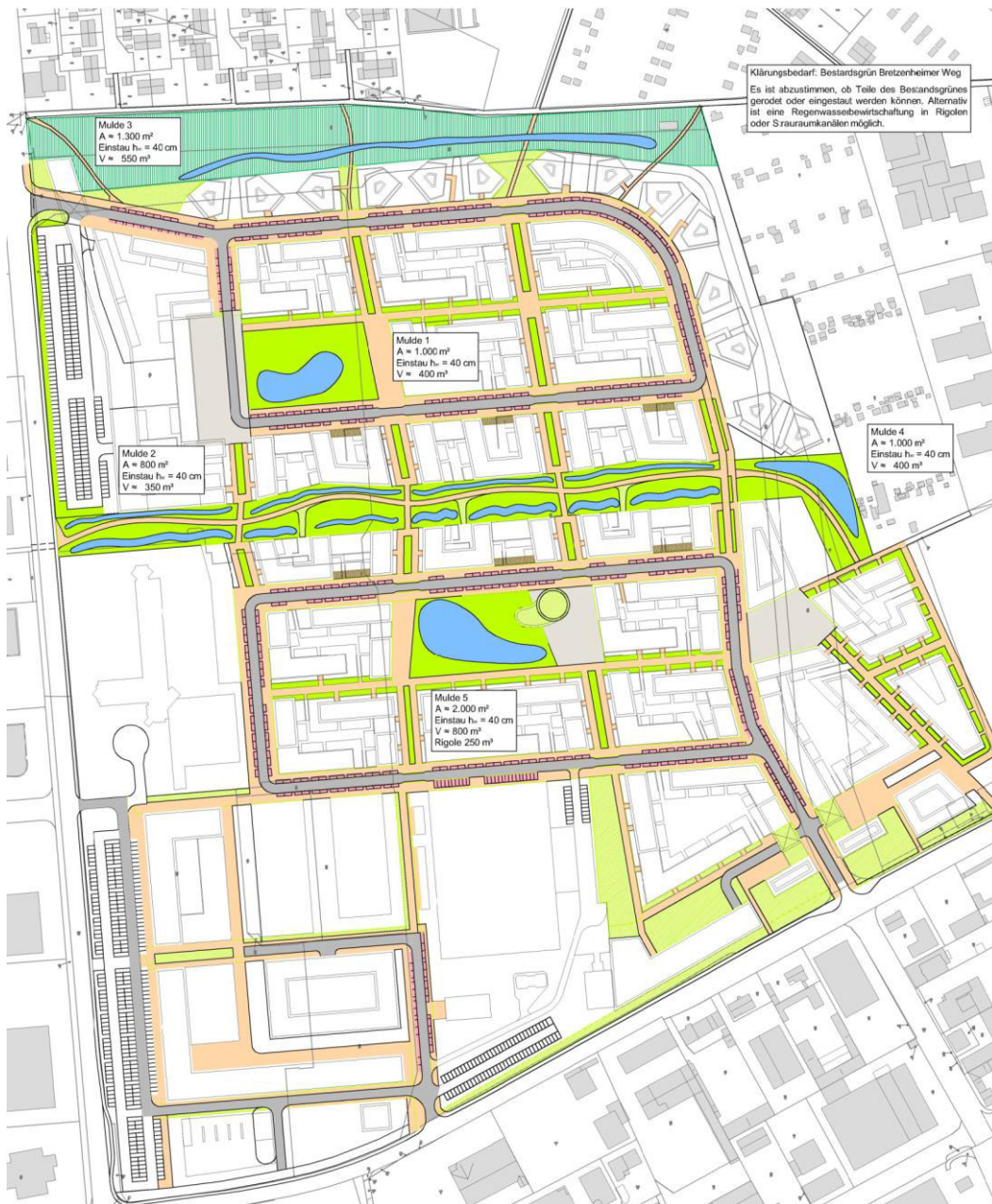
Abbildung 3 Lageplan Versickerungsanlagen Phase 1
