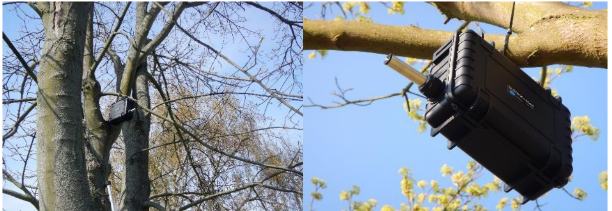
Abbildung 11: Rufaufzeichnungsapparat: Minicomputer Raspberry Pi in wetterfester Box mit USB- Mikrofon Dodotronic Ultramics 250 K [Fotos © J. Tauchert (Fa. BG Natur), 2016].
