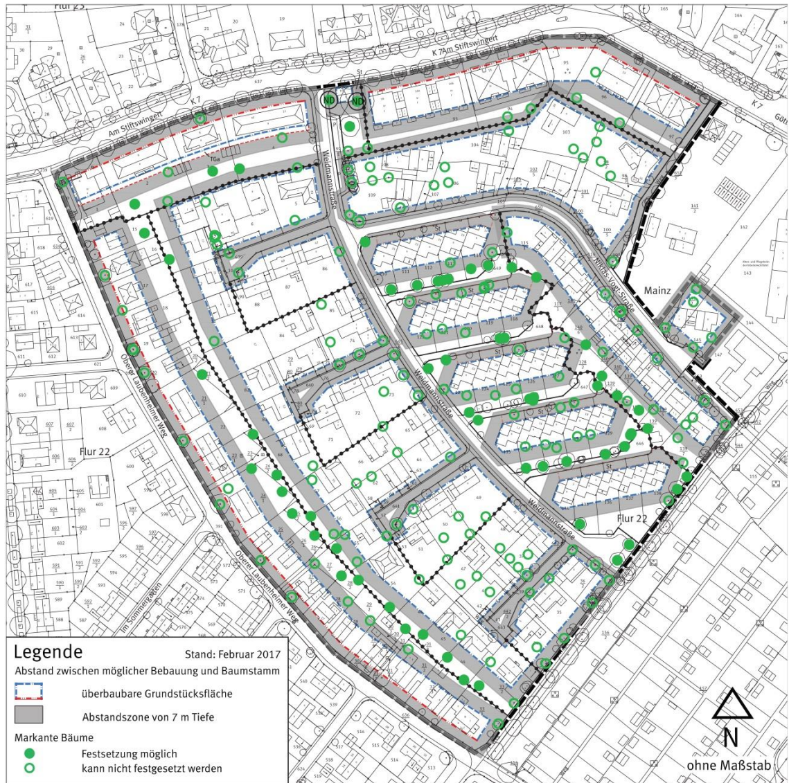
Abb.5 Selektion markanter Bäume für zeichnerische Festsetzung durch Abstandsmessung zu überbaubaren Grundstücksflächen
