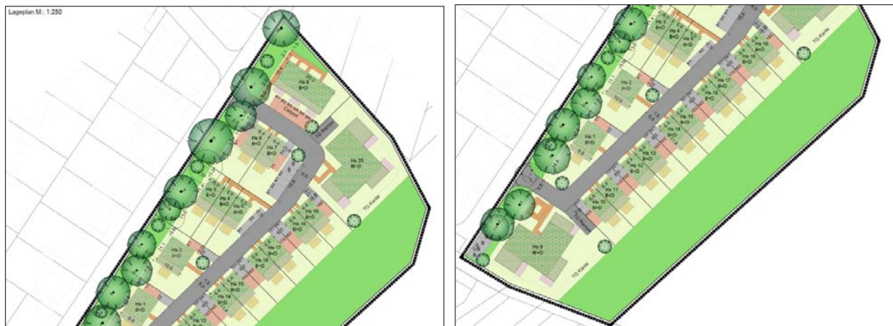
Abb. 14: Die eingemessenen Baumstandorte, zu fällende Bäume (ungefüllte Kreise) und Neuanpflanzungen (kleine Symbole). Ausschnitt Nord (links) und Süd (rechts) aus dem Arbeitsplan Entwurfskonzept mit Baugruben (Plan D°, Stand 22.06.2016)
