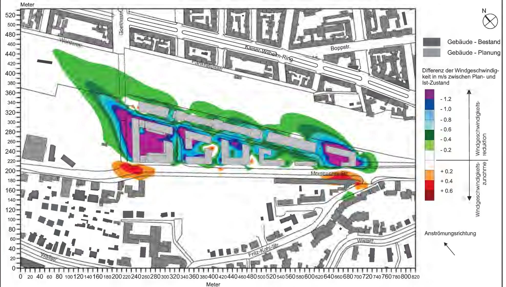
**Abb. 26.1 Ist-Zustand - Strömungssimulation (2 m ü.G.), Windanströmung aus Südwesten (220°) mit 2.0 m/s in einer Höhe von 10 m ü.G.**
