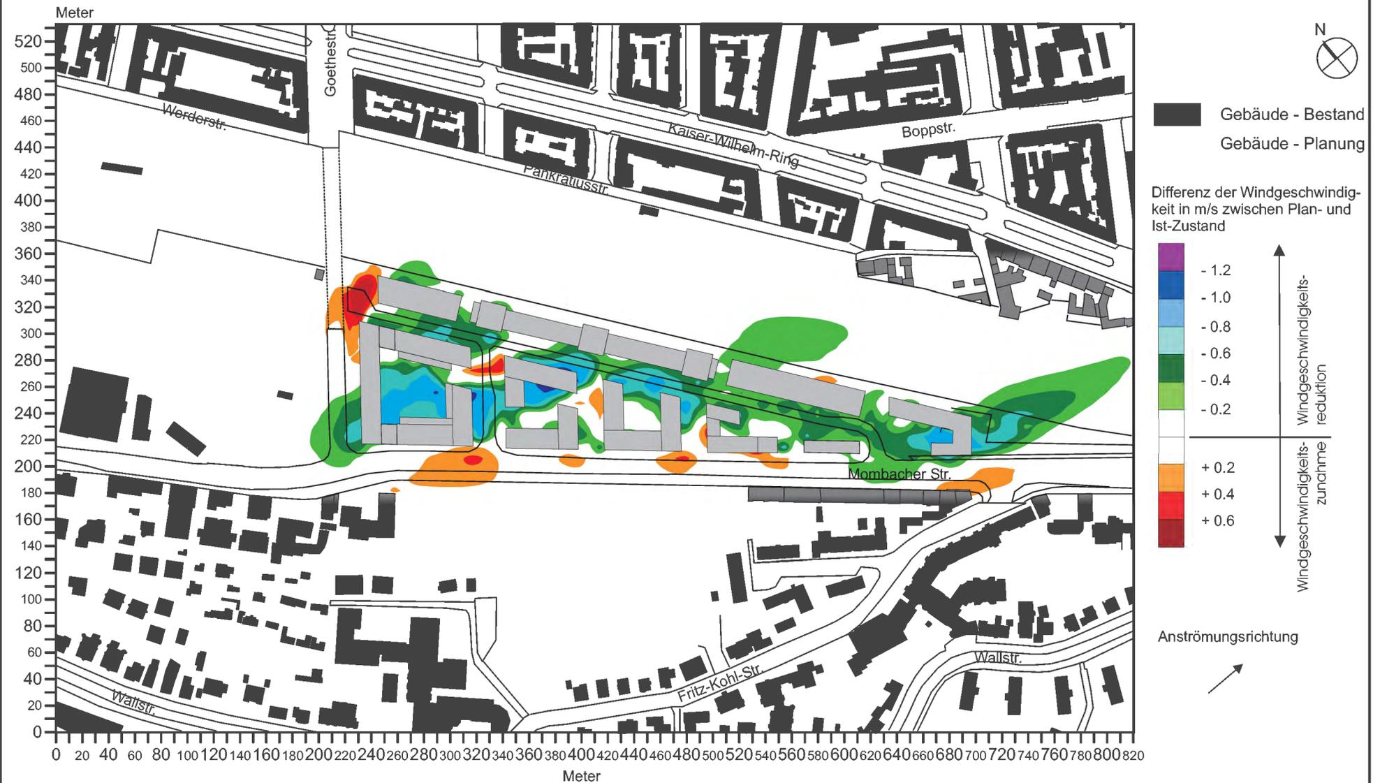
**Abb. 31.2** Modifikation des Windfeldes durch den Plan-Zustand gegenüber dem Ist-Zustand -
