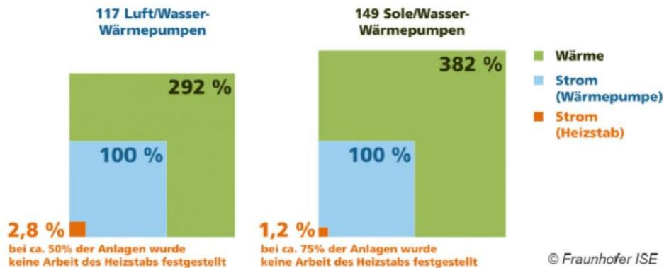
Abbildung 13: Zusammenhang Heizstab- und Wärmepumpeneinsatz<sup>9</sup>
